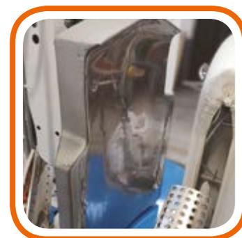
Piastre in fusione riscaldata a vapore ad alto risparmio/scambio termico.
