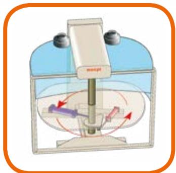
Rotazione veloce, ottenuta con l'applicazione di sistemi, pneumatici di spinta e oleodinamici di frenata.
