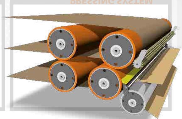
**macpi 341** è un'unità di termoadesivazione totalmente rivoluzionaria per gli alti contenuti tecnologici. Dalla struttura ai cinematismi e in particolar modo al riscaldamento, tutto è frutto della lunga esperienza maturata da macpi in tanti anni di sviluppo e produzione di macchine per adesivare, sempre nel rispetto della struttura del tessuto ottenuto mediante l'utilizzo di 4 cilindri di pressatura.
