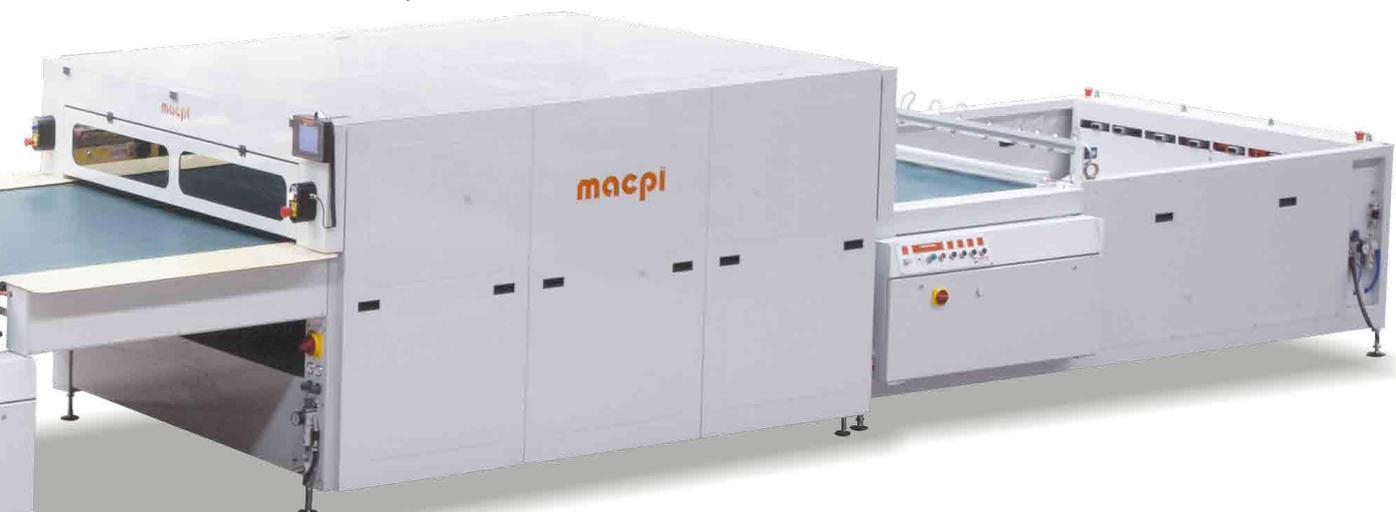
**macpi 341** può essere equipaggiata con caricatori e scaricatori automatici formando un GRUPPO DI ADESIVAZIONE completo. La termoadesivatrice, prodotta in larghezza 1400/1600/1800mm, adotta il sistema di riscaldamento modulare, cuore della macchina, che consente di adesivare utilizzando il vapore con risultati ineguagliabili.
